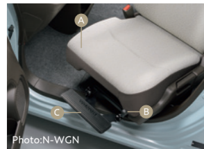
助手席回転シートは、前後のシートスライドはできません。
