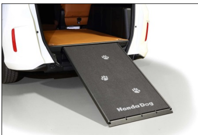
ビルトインスロープ
