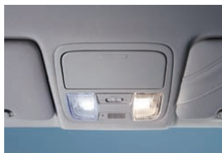
LEDルームランプ装着例 左がLEDルームランプ、右は標準ランプ
